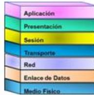
El modelo OSI tiene como virtud separar en siete niveles las diferentes tareas de comunicación y cada una de las cuales tiene asociado un protocolo, el modelo OSI sirve como base para la mayor parte de las Redes Industriales. En las Redes industriales no son utilizados todos los niveles del modelo OSI, encontrando dos tipos usuales de redes industriales:
